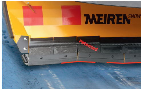
Patentoidut, tienpintaa kopioivat teränpidikkeet
